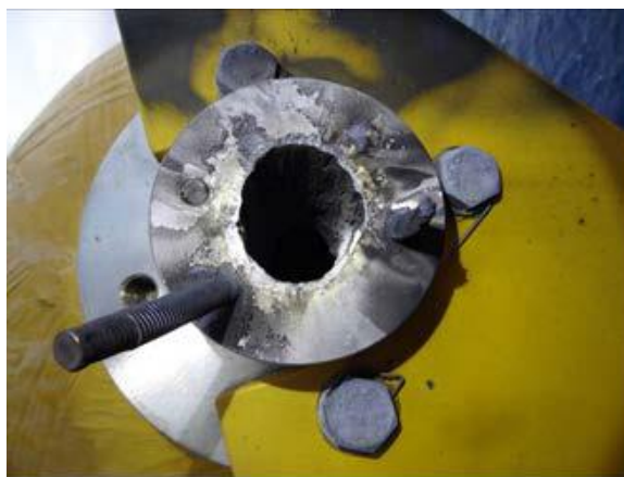
Brida de salida del CAPV
