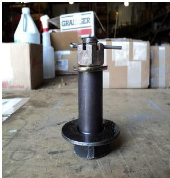
Pasador nuevo para la bisagra de la plataforma de varillas
