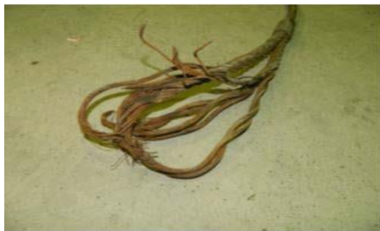
Línea partida de la brida del tanque.
