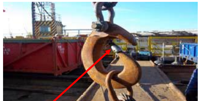
Nuevo mecanismo de cierre instalado como resultado del incidente.
