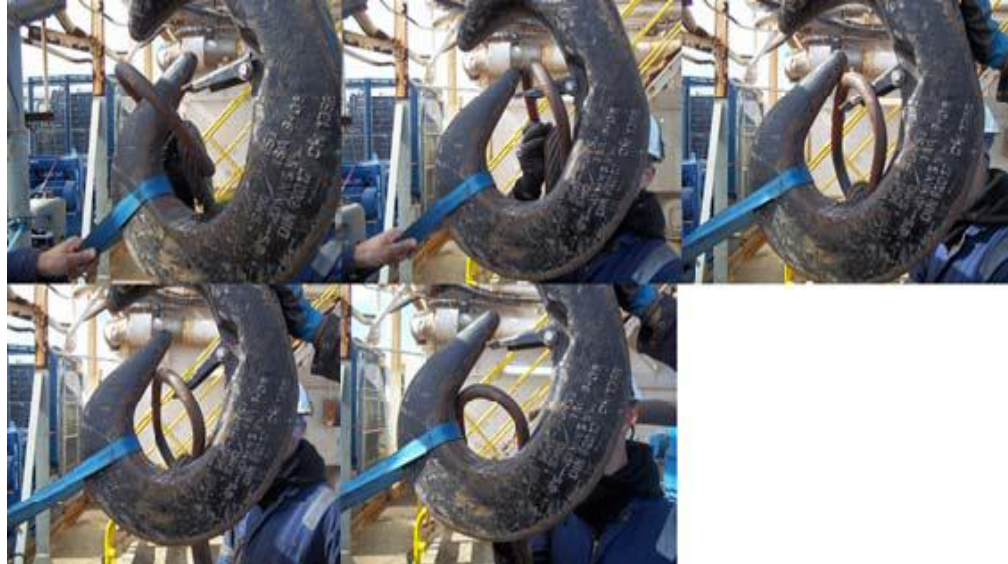
Simulación del colgador saliéndose del gancho.
