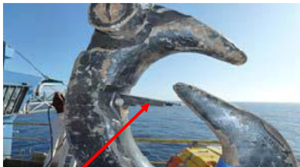
Gancho retráctil utilizado y que resultó en el incidente.
